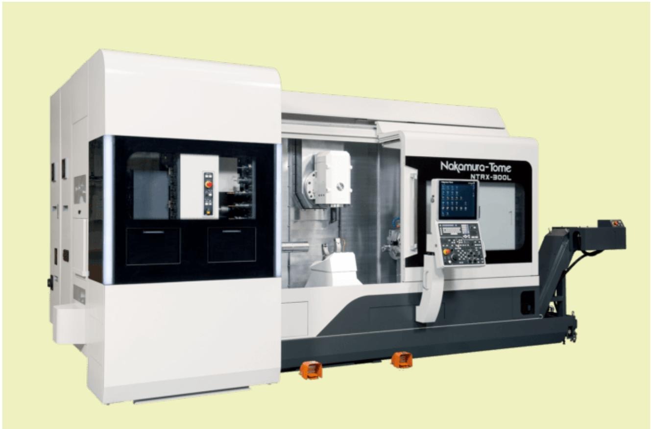
Das 5-Achs-Bearbeitungszentrum mit schwenkbarer Frässpindel zur Komplett-Bearbeitung in einem Arbeitsgang, mit hoher Präzision, kurzen Durchlaufzeiten und kurzen Umrüstzeiten beim Wechsel von einem Werkstück zu einem anderen. Wirtschaftliche Fertigung komplexer Werkstücke auch in kleinen Losgrößen.
