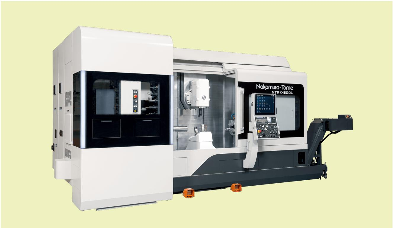
Das 5-Achs-Bearbeitungszentrum mit schwenkbarer Frässpindel zur Komplett-Bearbeitung in einem Arbeitsgang, mit hoher Präzision, kurzen Durchlaufzeiten und kurzen Umrüstzeiten beim Wechsel von einem Werkstück zu einem anderen. Wirtschaftliche Fertigung komplexer Werkstücke auch in kleinen Losgrößen.
