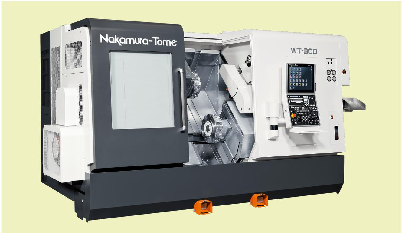
Die grösste der Multitasking-Doppel-Revolvermaschinen, ebenfalls mit handgeschabten Flachführungen in allen Achsen. Dieses Kraftpaket besticht mit zahlreichen Updates wie z.B. dem Stangendurchlass bis 102 mm.
