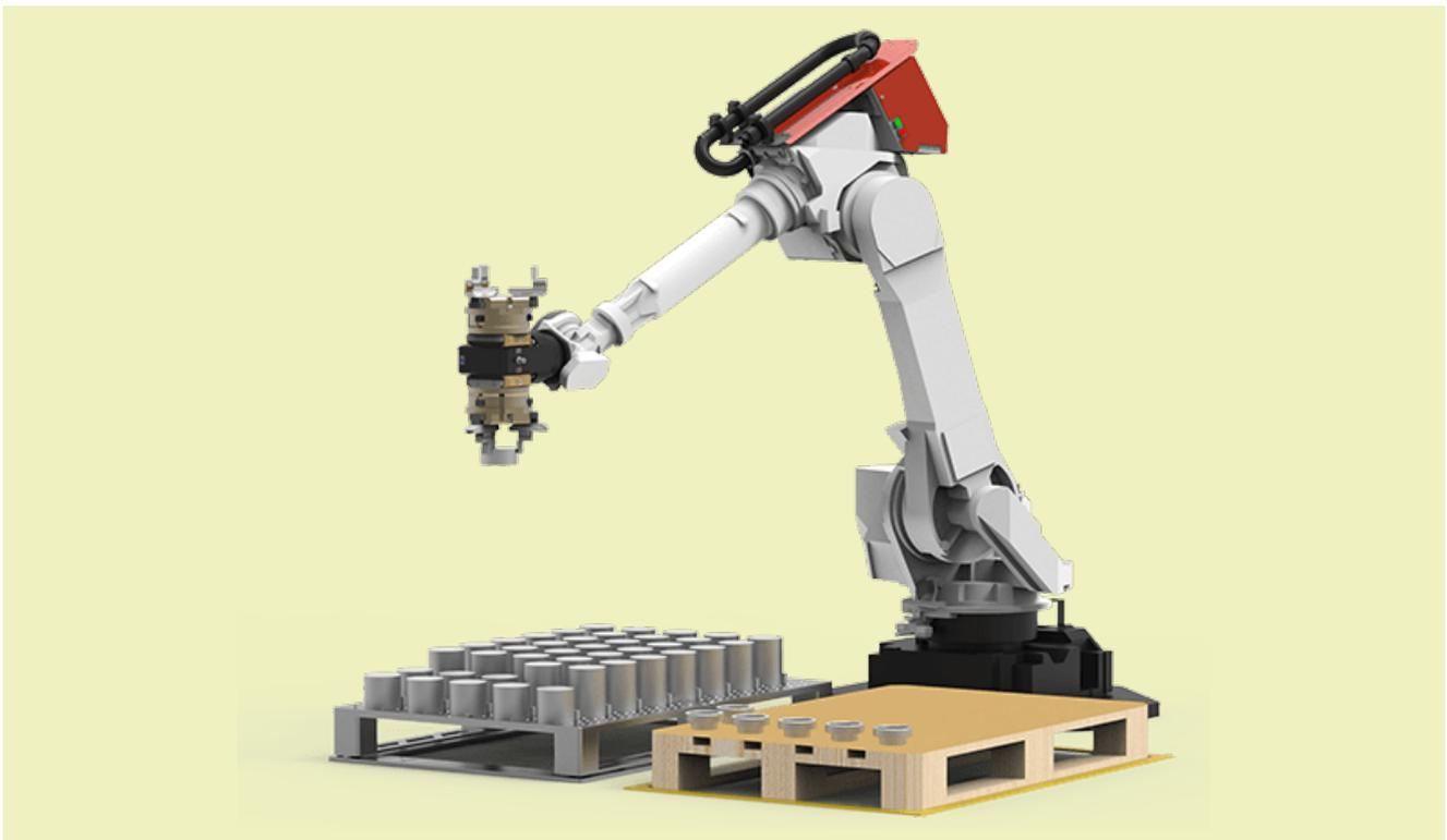
Die konfigurierbare Palette für Rohteile wird in der ersten Position platziert. Wie bei Pallet-Load Single können Sie diese Palette mit den bereitgestellten Werkzeugen konfigurieren. Sie können dann Ihre Rohteile auf dieser Palette positionieren. Darüber hinaus können diese Teile auch gestapelt werden, wodurch Sie noch mehr Kapazität erhalten.
