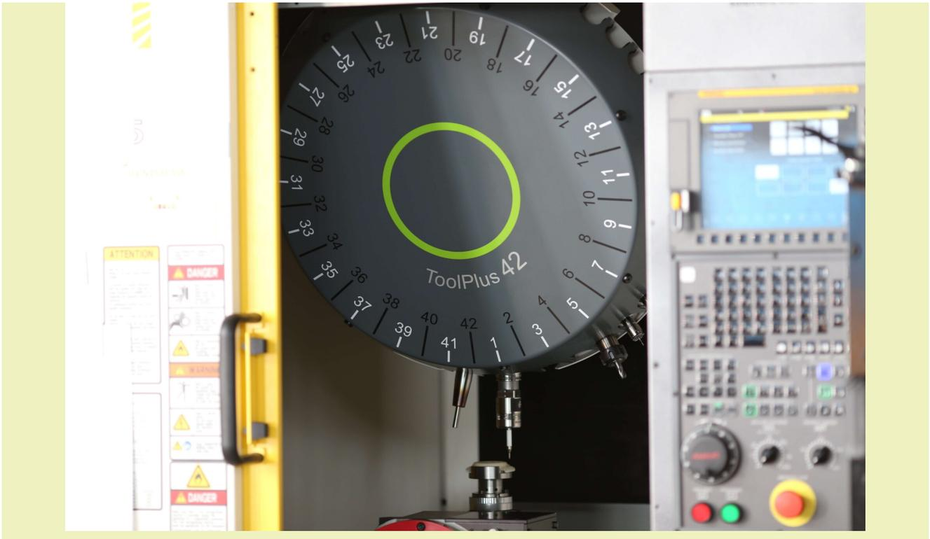
WM ToolPlus® ist eine Erweiterung des Werkzeugmagazins, welche von Walter Meier für die Fanuc Robodrill entwickelt wurde. Dadurch können in komplexen Produktionsprozessen Arbeitsgänge eingespart und die Fertigungskosten gesenkt werden. Die Wechselmechanik wurde weitgehend beibehalten, sodass sich WM ToolPlus® nicht auf die Wechselzeiten auswirkt.
