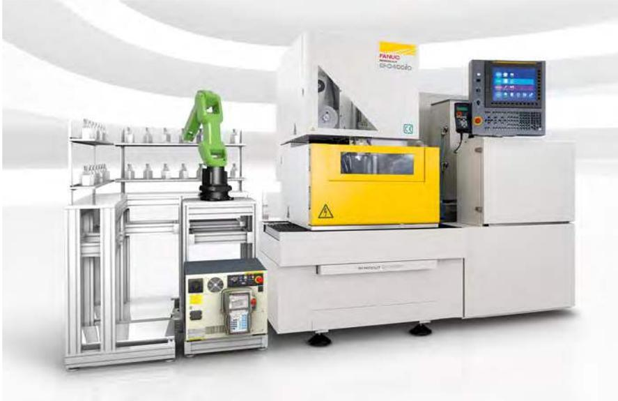
ROBOCUT wurde für eine einfache Automatisierung konzipiert und verfügt über einen ergonomisch gestalteten Arbeitsbereich sowie einen einfachen Roboterzugang zum Beladen schwerer Werkstücke und eine problemlose Maschinenbedienung.
