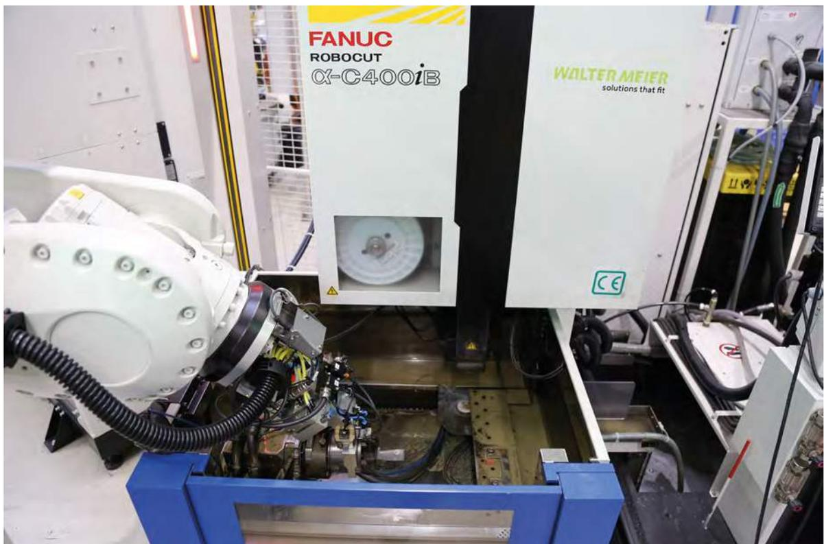
Praxisbeispiel einer Automatisationslösung mit seitlicher Bestückung der Erodiermaschine FANUC Robocut alpha C400iB
