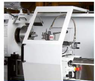
Capot de protection coulissant avec vitre de sécurité
