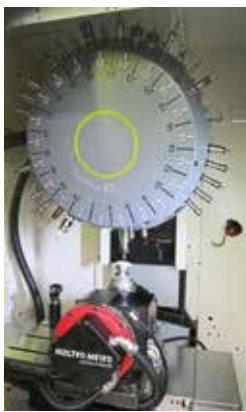
Centre d'usinage vertical Fanuc-31i-B5 5 axes completé par une unité de mesure scanflash ESPI et d'un robot Fanuc pour la manutention.
