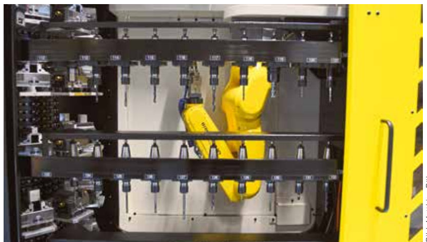
Geniale Lösung: Im Bild frontal der externe Werkzeugspeicher mit 44 zusätzlichen Werkzeugen. Links davon die 60 Werkstückpaletten. Der Knickarmroboter «handelt» beides.
