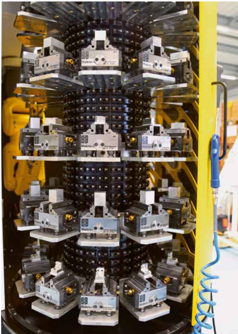
Blick auf den Palettenspeicher, auf dem sowohl Grossserien als auch komplett unterschiedliche Werkstücke und Kleinserien gespeichert werden können.
