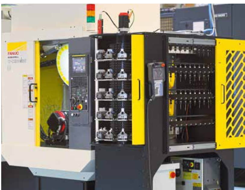
100 Prozent ausgereiftes Maschinen- und Automationskonzept: extrem kompakte Bauweise, 5-Achs-Bearbeitungszentrum mit Werkzeug- und Palettenspeicher sowie Spänemanagement auf unter 6 Quadratmeter Fläche für mannlose Schichten. Zu sehen ist zudem der integrierte Werkzeugspeicher für zusätzliche 44 Werkzeuge.
