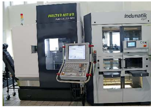
Eine Fertigungslösung bestehend aus Fertigungszentrum (5-achsig), Palettisierung und Werkzeugspeicher. So können mannlose Schichten gefahren werden.
